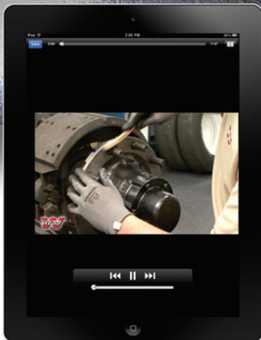
**VIDÉOS DE FORMATION.** La section Vidéo offre des vidéos de formation qui vous aideront à réduire vos coûts d'exploitation. Les vidéos sur l'installation vous montrent les techniques d'installation appropriées pour les roues à guides de moyeu (FN) et les roues à goujons guides (BSN). Une troisième vidéo montre les conséquences d'une installation inappropriée et montre comment choisir le tambour de frein approprié pour votre application.
