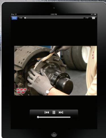
**VIDEOS DE CAPACITACIÓN.** La sección de videos contiene videos de capacitación que ayudan a reducir los costos de mantenimiento. Los videos de instalación se enfocan en las técnicas adecuadas de instalación del piloto de la maza (FN) y birlos (BSN), las consecuencias de una instalación inapropiada, y cómo seleccionar el tambor de freno adecuado para su aplicación.
